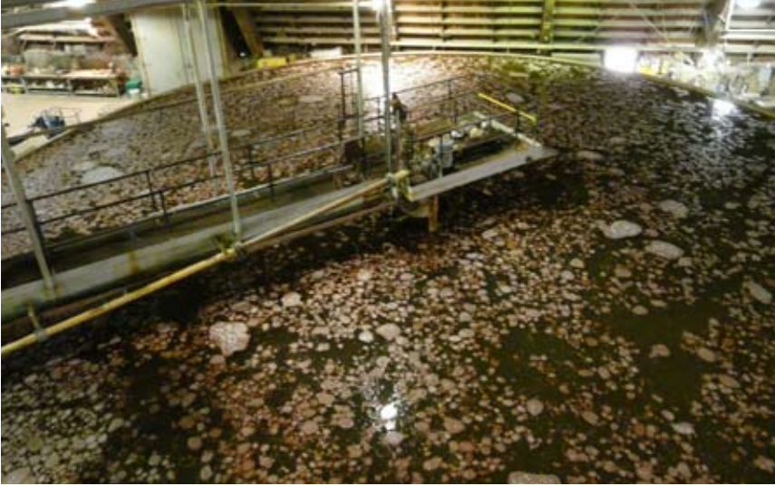
ภาพที่ 4.1 บ่อลอยแร่ ซึ่งใช้น้ำปริมาณมาก ของบริษัท Potash Corporation ประเทศแคนาดา อนุเคราะห์ภาพโดย: มหาวิทยาลัยราชภัฏอุดรธานี
