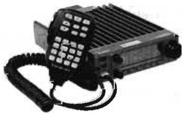
วิทยุสื่อสารประจำรถพยาบาลฉุกเฉิน (Mobile unit) กำลังส่ง 10-25 วัตต์
