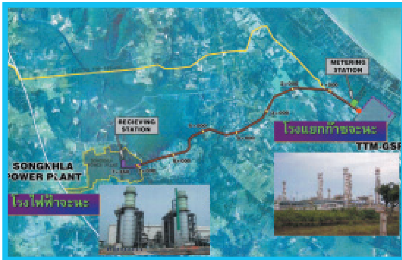
ภาพที่ 5 : แสดงโรงแยกก๊าซจะนะ ที่มีท่อส่งก๊าซ(สีแดง)มายังโรงไฟฟ้าจะนะ เหตุที่ท่อส่งก๊าซคัดเดี่ยวเหมือนงูเลื้อยก็เพราะชาวบ้านบางส่วนไม่ยอมขายที่ดินให้เท่านั้น
