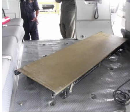
ภาพแสดงการติดตั้งเปลพยาบาล ประจำ ฮ. S - 76B และ SUPER LYNX 300
