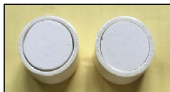
ภาพต้นแบบของเซรามิกรูปวงรีที่ใช้บรรจุสารสกัดจากตะไคร้ เพื่อกำจัดไรผึ้ง
