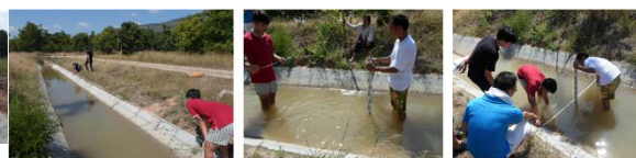
วัดขนาดหน้าตัดและความลึกของน้ำในคลองสำหรับการคำนวณหาการรั่วซึม
